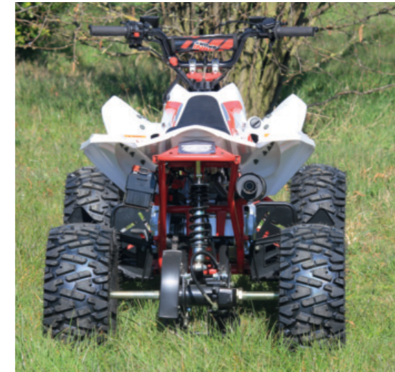
Bodenständig: Breite Aufstandsfläche gegen die Kippneigung und schmale Karosserie für die Bewegungsfreiheit.
